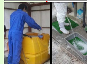
消毒液の定期的交換
